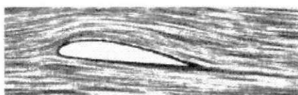
Figura 22 - Fluxo aderente ao perfil da pá eólica
