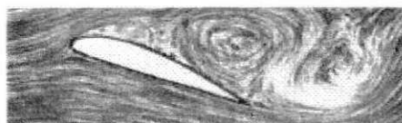
Figura 21 - Fluxo separado (estol) em volta do perfil da pá eólica
