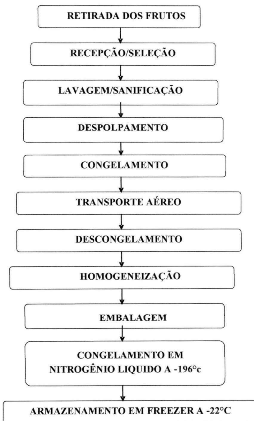
Figura 3.2. Fluxograma das etapas realizadas para a obtenção da polpa de buriti
