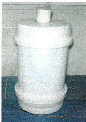
Figura 3.1. Equipamento utilizado para determinação do calor específico (Fonte: Autor)
