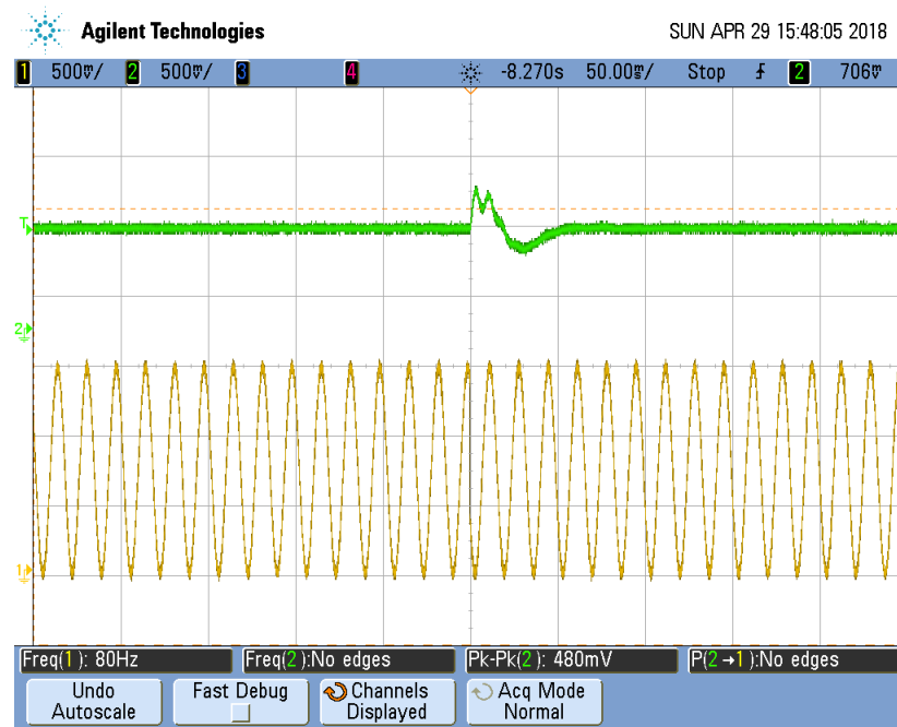
Figura 5.15 – Resultados experimentais do SOGI-PLL durante o salto de fase. Tensão de entrada (amarelo) e sinal de erro (verde).
