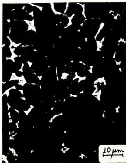
Fig. 15 - Micrografia eletrônica de varredura de amostras do Sistema 05 ( 95\text{ZnO} \cdot 3\text{Bi}_2\text{O}_3 \cdot \text{CO}_3\text{O}_4 \cdot \text{MnO}_2 ).
