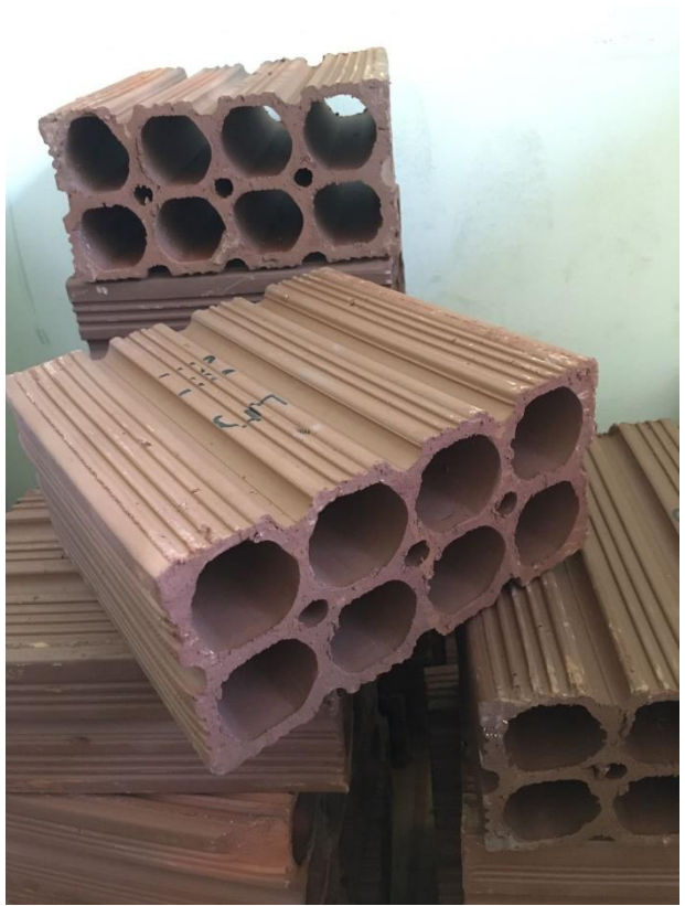
Figura 2 – Amostra sem presença de deformação e trinca. (Fonte: O autor, 2022)
