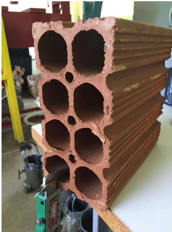
Figura 17 – Medição da parede externa com paquímetro. (Fonte: O Autor, 2022)
