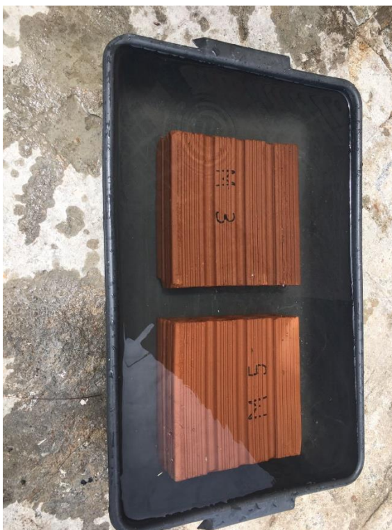
Figura 19 – Amostras submersas em água a temperatura ambiente. (Fonte: O Autor, 2022)
