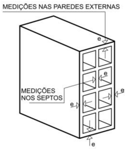
Figura 15 – Relação esquemática das medições dos septos e paredes externas. (Fonte: ABNT NBR 15270:2005)
