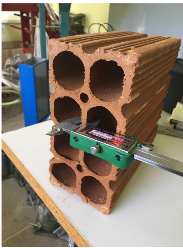
Figura 16 – Medição do septo interno com paquímetro. (Fonte: O Autor, 2022)
