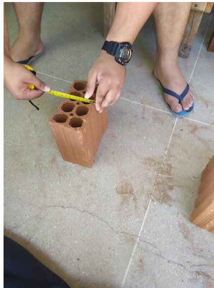
Figura 9 – Realizando a medição da largura da amostra. (Fonte, O Autor, 2022)
