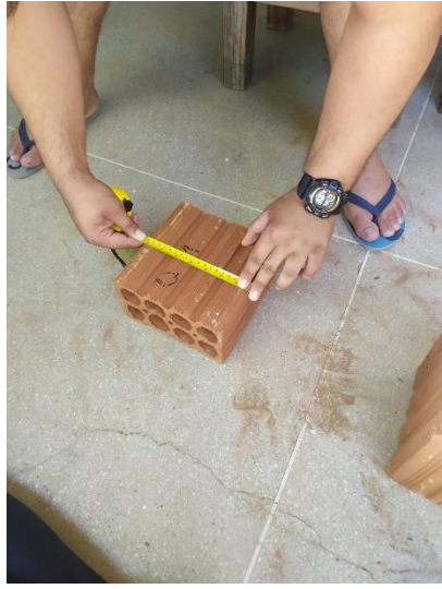
Figura 7 – Realizando a medição da altura da amostra. (Fonte: O Autor, 2022)
