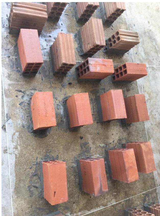
Figura 20 – Capeamento das amostras em uma superfície plana e com uma leve camada de óleo. (Fonte: O Autor, 2022)
