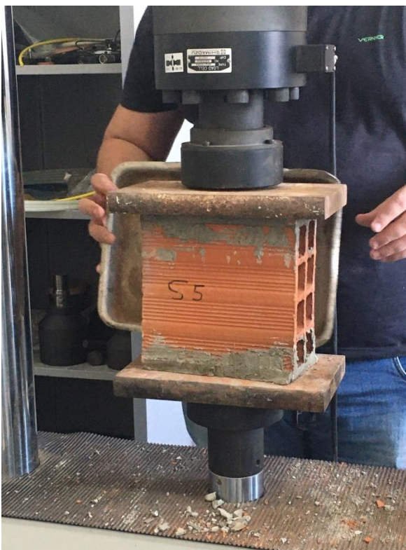
Figura 23 – Amostra na prensa com o apoio das placas de aço. (Fonte: O Autor, 2022)
