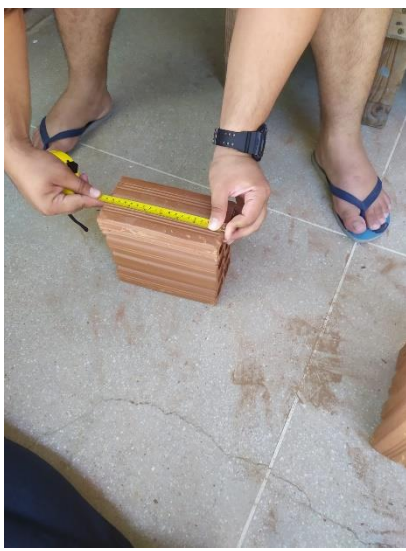
Figura 8 – Realizando a medição do comprimento da amostra. (Fonte: O Autor, 2022)
