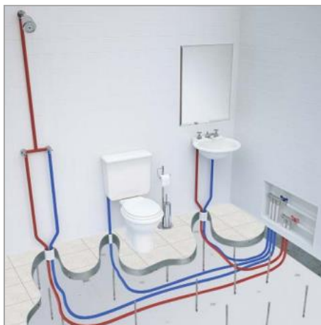
Figura 5 – Instalação do sistema ponto a ponto (Manifold). (Fonte: TIGRE, 2016)
