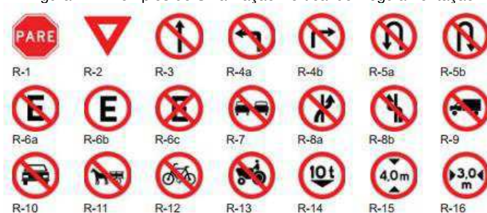
Figura 1 – Exemplos de Sinalização Vertical de Regulamentação
