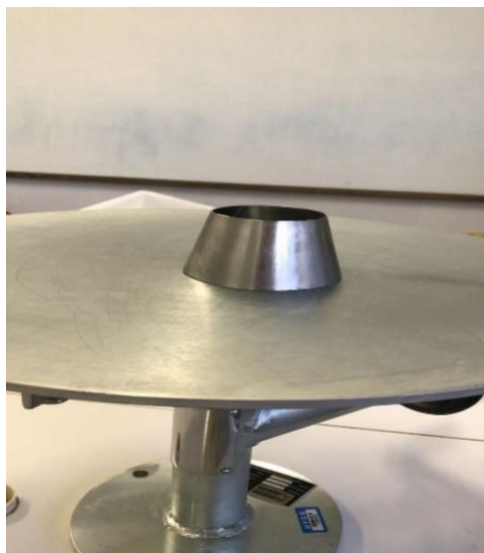
Figura 16 - Equipamentos utilizados no mini slump
