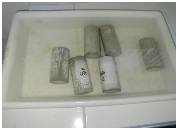
Figura 22 - Ensaio de absorção por imersão: amostra imersa na água
