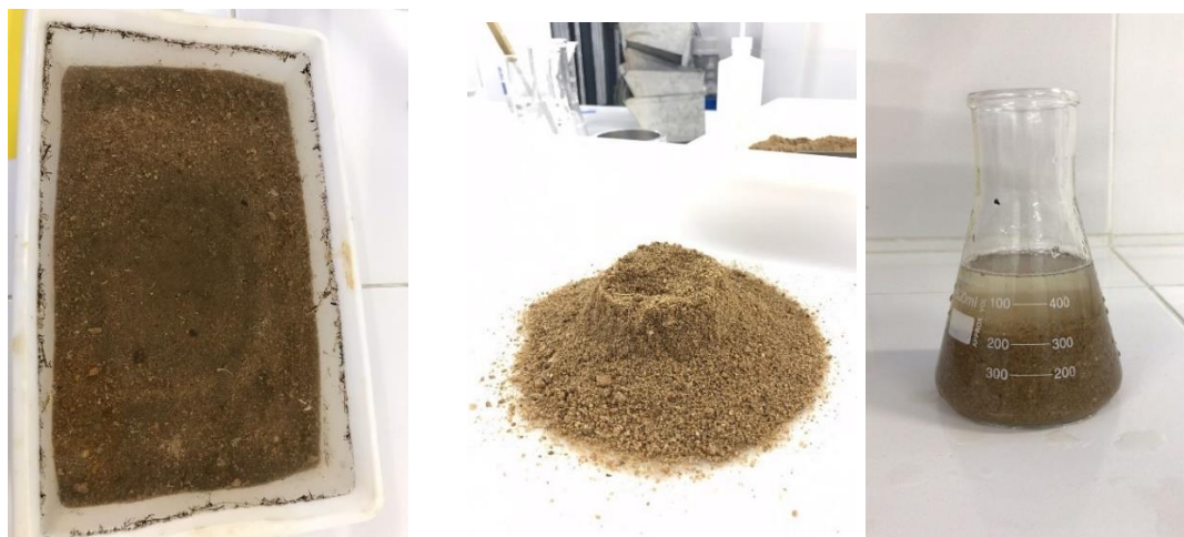
Figura 10 - Determinação da massa específica: (a) Preparação da amostra; (b) Amostra com formato do molde tronco-cônico; (c) Frasco com amostra
