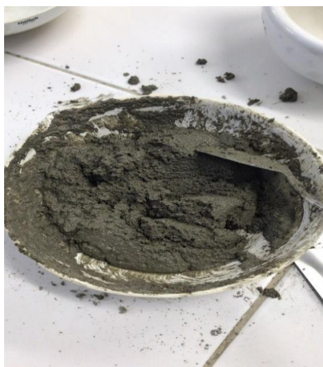
Figura 14 - Argamassa enrijecida após uso do AMV
