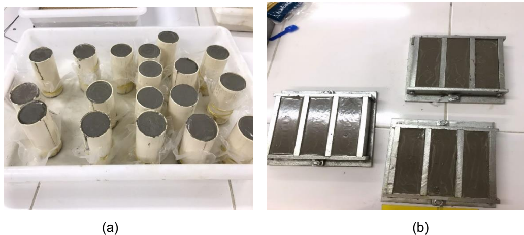
Figura 18 - Moldagem dos corpos-de-prova: (a) Cilíndricos; (b) Prismáticos
