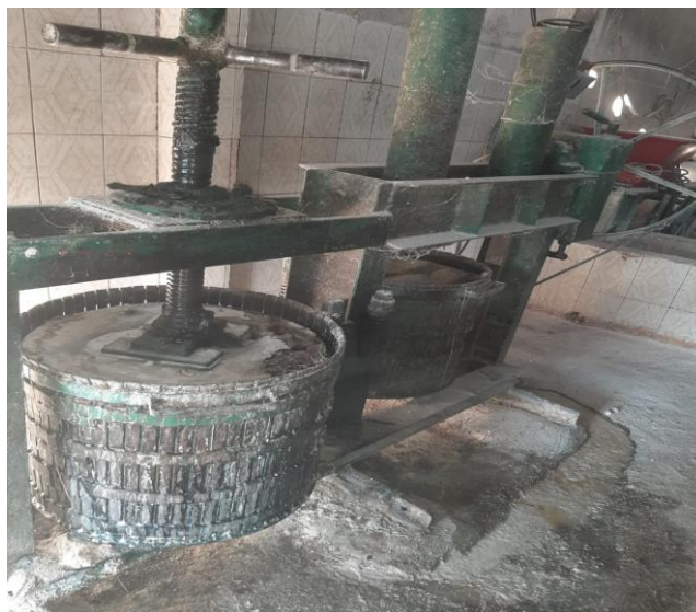
Figura 4. Prensagem separando a biomassa do líquido.
