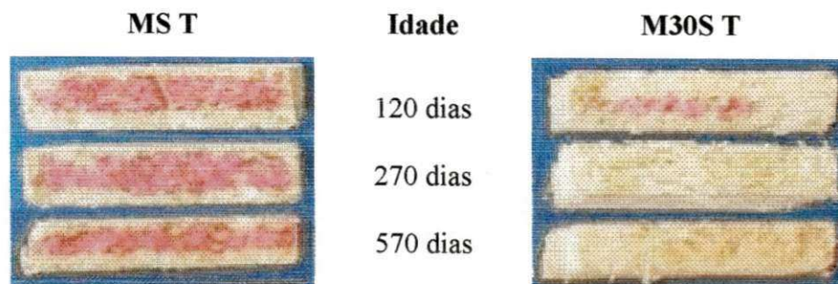
FIGURA 4.14 – Superfície de fratura de corpos de prova retirados de telhas submetidas ao intemperismo natural em diferentes idades
