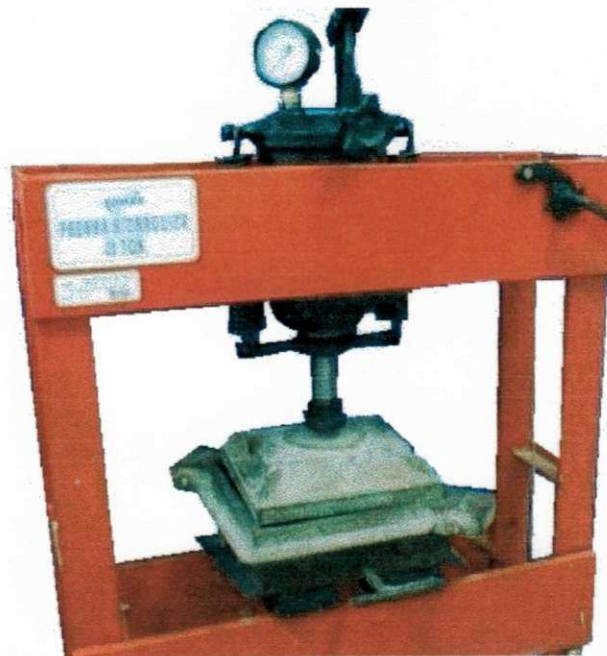
FIGURA 3.4 – Prensa e molde metálico usados para produção dos compósitos estruturais
