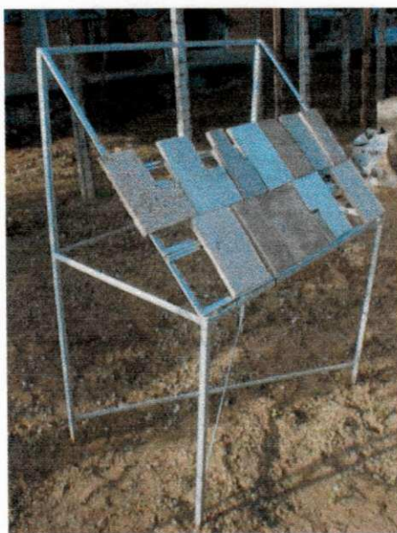
FIGURA 3.8 – Placas expostas ao intemperismo natural para estudos de durabilidade
