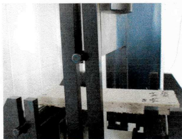
FIGURA 3.7 – Detalhe dos apoios e do corpo-de-prova antes do ensaio de flexão
