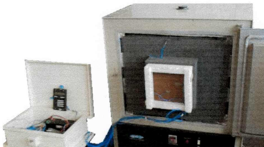
FIGURA 5.7 – Equipamentos utilizados no ensaio de comportamento térmico dos compósitos leves
