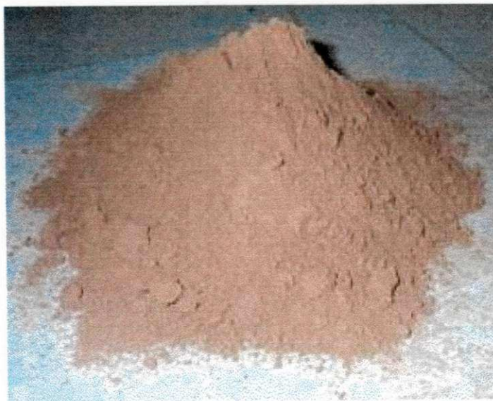
FIGURA 3.2 – Resíduos de blocos cerâmicos após moagem
