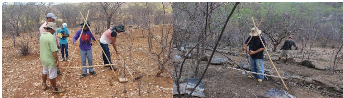
Figura 3. Utilização do instrumento Pé de Galinha para confecção de curvas de nível mestra.
