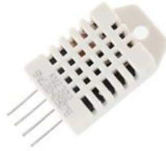
Figura 4. Sensor AM2302 DHT22. Fonte: Aosong (2019a).
