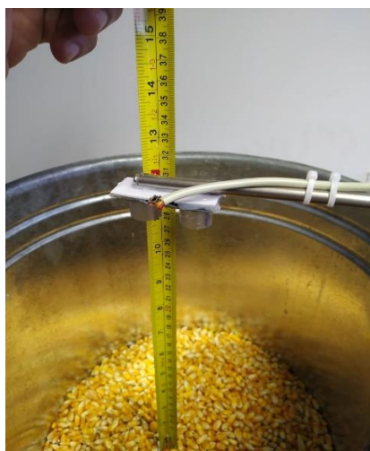
Figura 10. Calibração do sensor de nível de grãos.
