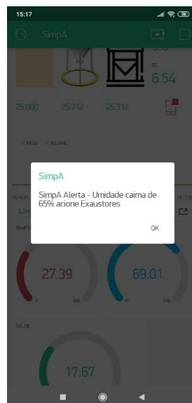
Figura 31. Tela do sistema de alerta quanto a umidade.
