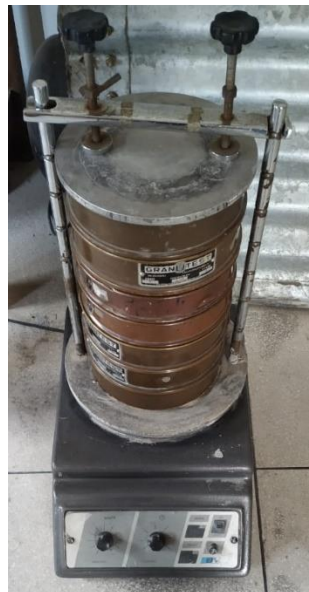
Figura 20. Equipamento agitador com peneiras utilizado no ensaio granulométrico.
