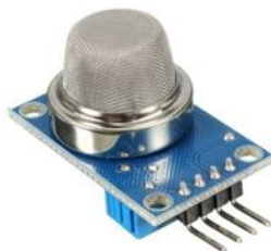
Figura 8. Sensor MQ-135. Fonte: Hanwei (2019).
