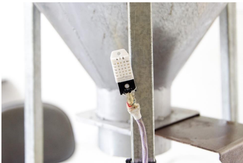
Figura 22. Sensor de umidade externo.
