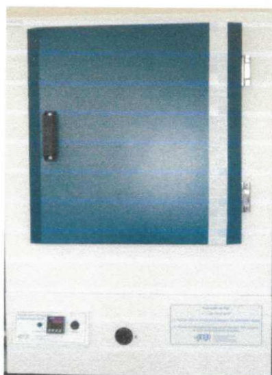
Figura 3.4. Estufa utilizada na secagem das folhas em camada espessa
