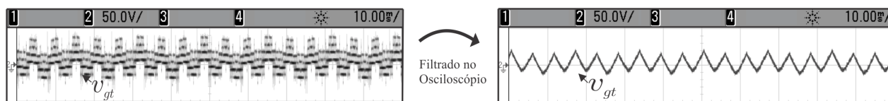
Figura 3.14: Resultados experimentais: Tensão de modo comum v_{g0} para para um cenário senoidal e m_a = 0,63 - HY6L.
