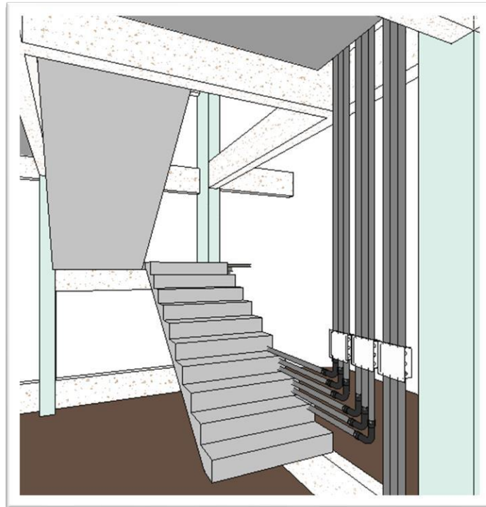
Figura 11 - Interferência entre eletrodutos e escada
