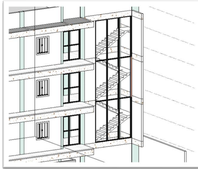
Figura 3 - Interferência entre parede cortina e pilar
