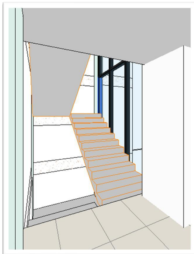
Figura 4 - Interferência entre escada e parede cortina
