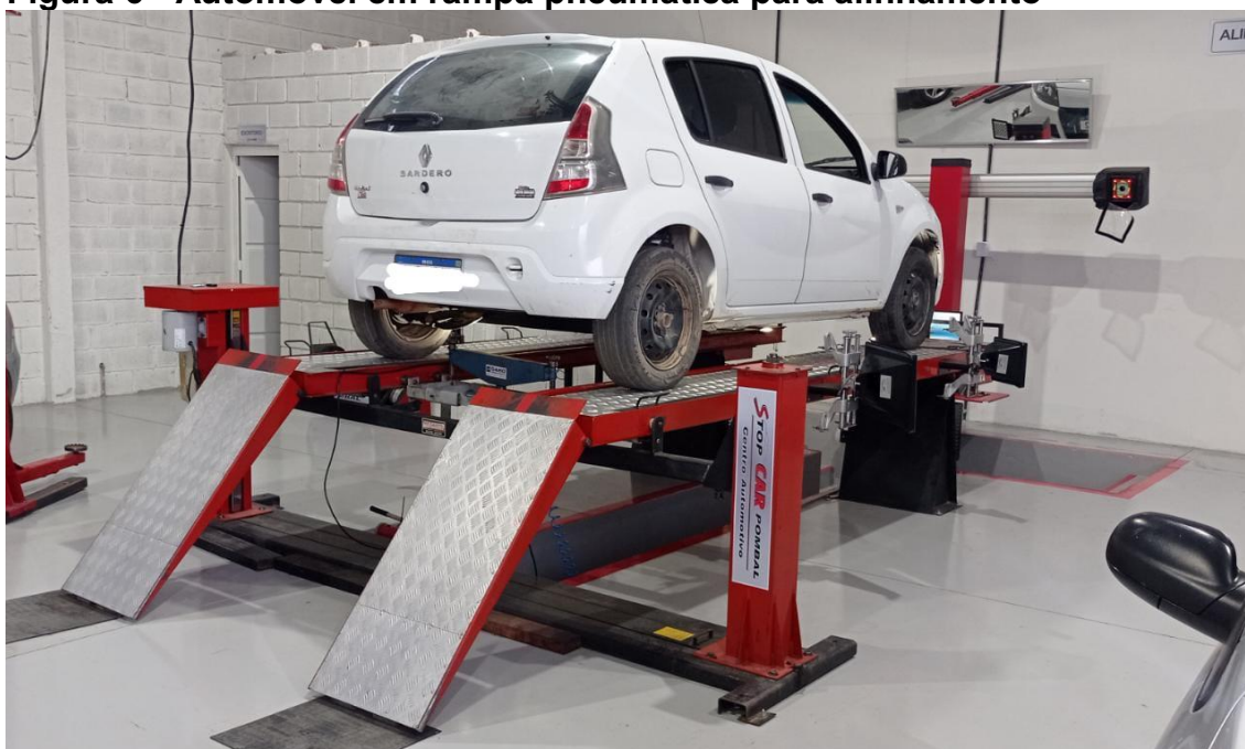
Figura 6 - Automóvel em rampa pneumática para alinhamento
