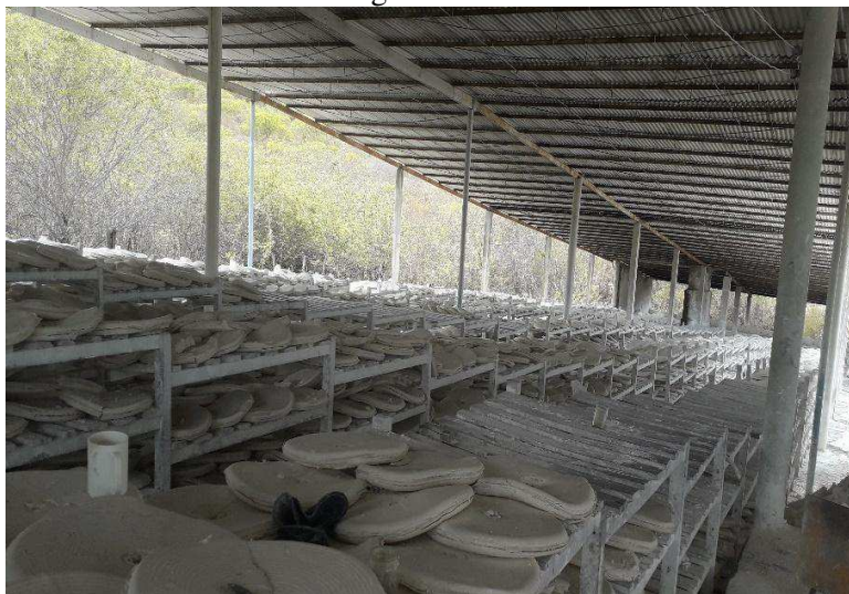
Foto 3 - Processo de secagem dos discos de caulim. Visita ao decantamento do Bonfim/Salgadinho–PB.
