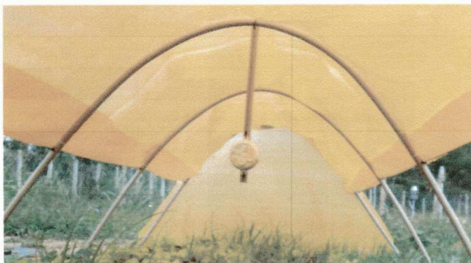
Figura 24 - Fixação do datalogger na estrutura.
