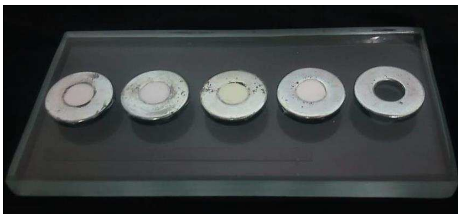
Figura 19 - Anéis metálicos usados na determinação do tempo de presa.
