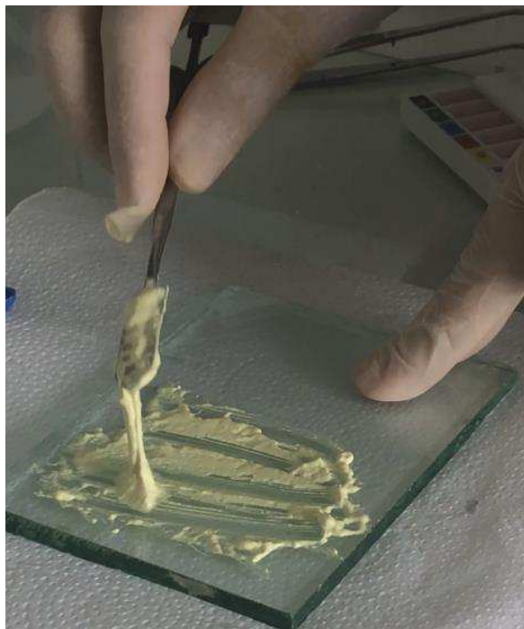
Figura 17 - Ensaio de escoamento vertical aplicado aos cimentos.
