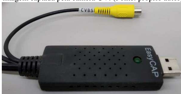
Figura 4.2. Fotografia do modelo de placa de captura utilizado com solução para melhoria da resolução da imagem captada pela câmera UV. (Fonte: próprio autor)
