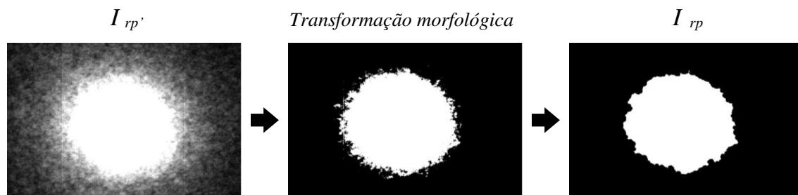
Figura 4.6. Processo de segmentação para se obter a região principal de análise e extração de atributos. (Fonte: próprio autor)
