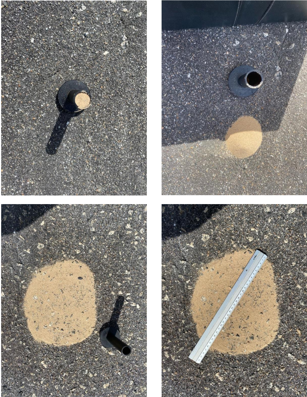
Figura 21 – Momentos do ensaio de Macrotextura
