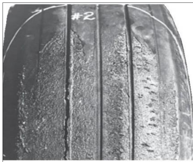
Figura 14 – Zona de Contato de um Pneu após um evento de hidroplanagem por desvulcanização.
