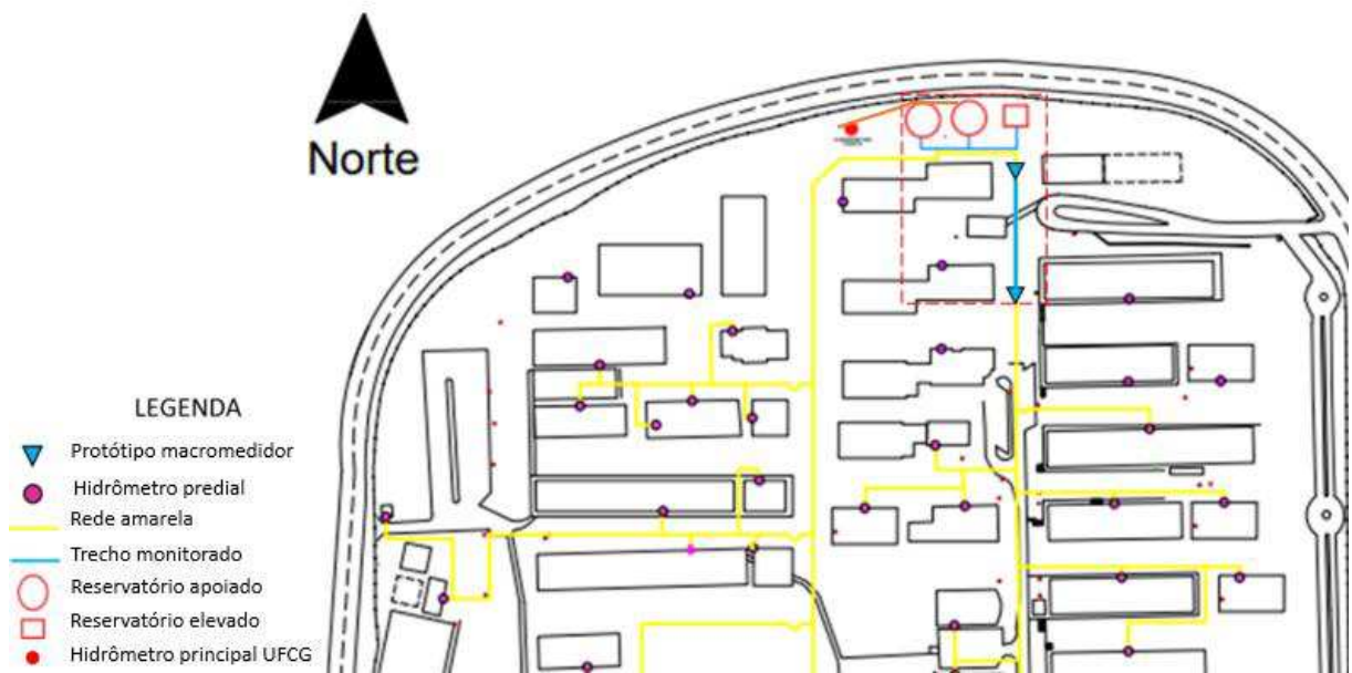
Figura 18 - Posicionamento do protótipo dentro da rede de distribuição de água da UFCG
