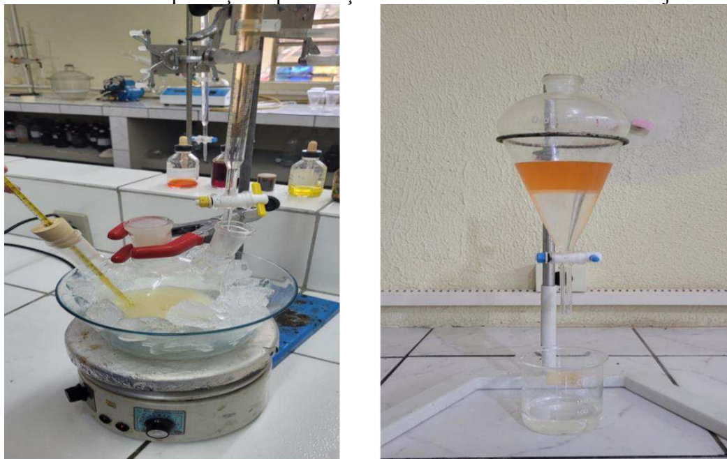
Figura 4 - Processo de produção e purificação do biolubrificante de óleo de soja comercial
