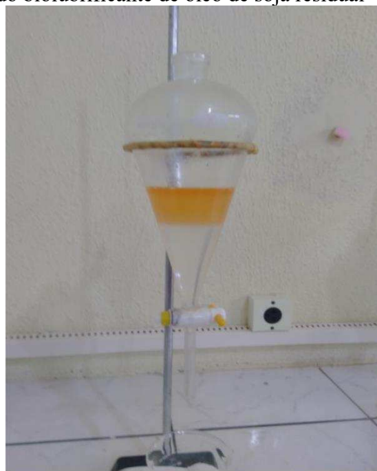
Figura 3 - Processo de produção e purificação do biolubrificante de óleo de soja residual
