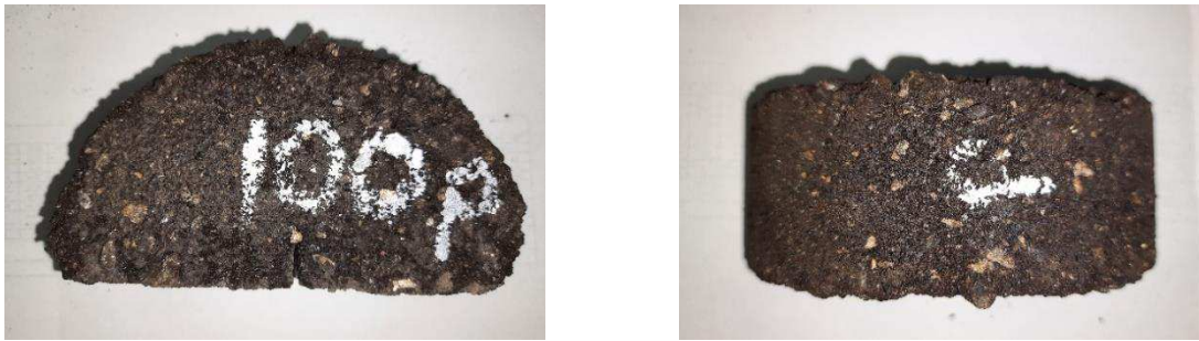
Figura 26 – Corpo de prova com 100% RAP, vista frontal (a) e vista superior (b).
