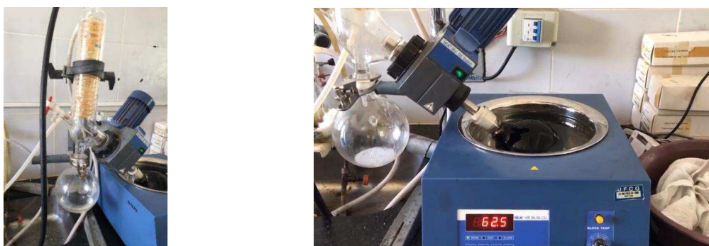
Figura 22 – Evaporador rotativo para recuperação de ligante asfáltico.
