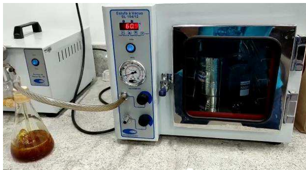
Figura 23 – Recuperação do ligante envelhecido, estufa a vácuo.
