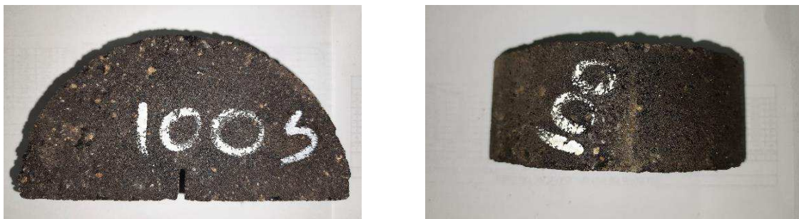
Figura 27 – Corpo de prova com 100% RAP com ADCAP WM, vista frontal (a) e vista superior (b).
