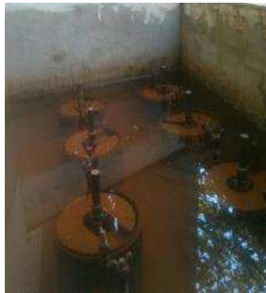
Figura 42 – (a) e (b) - Ensaio para determinação do índice CBR e Expansão das amostras
