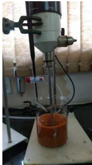
Figura 33 - Aparelhagem do ensaio de azul de metileno
