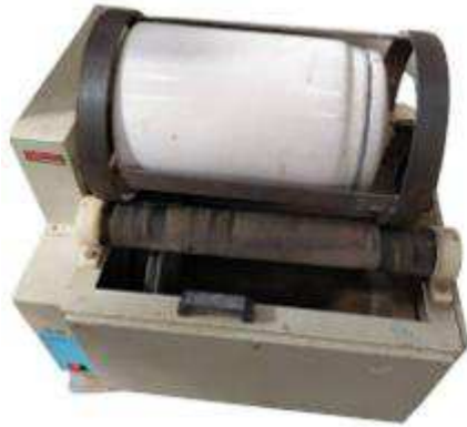
Figura 36 - Moinho de bolas empregado no ensaio de friabilidade
