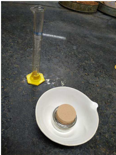
Figura 34 – (a) e (b) - Ensaio de limite de contração
