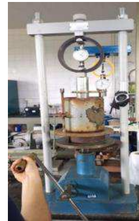
Figura 42 – (a) e (b) - Ensaio para determinação do índice CBR e Expansão das amostras
