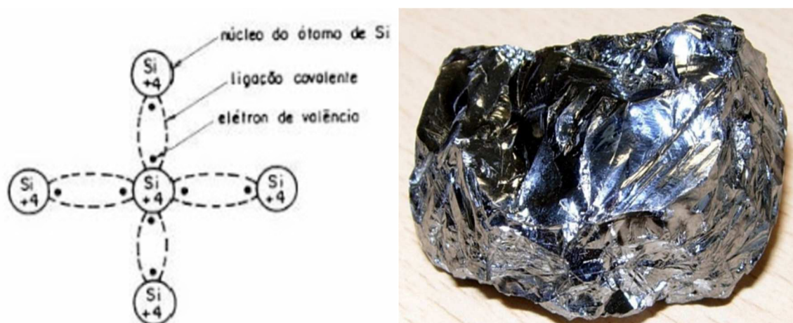
Figura 2.10 – Modelo Atômico + Cristal de Silício.
