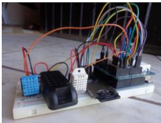
FIGURA 12 - DATALOGGER MONTADO NA PROTOBOARD
