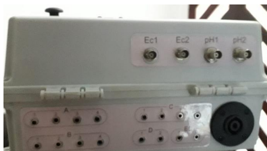
FIGURA 6 - TERMINAIS PARA O SENSORES DO GT-01
