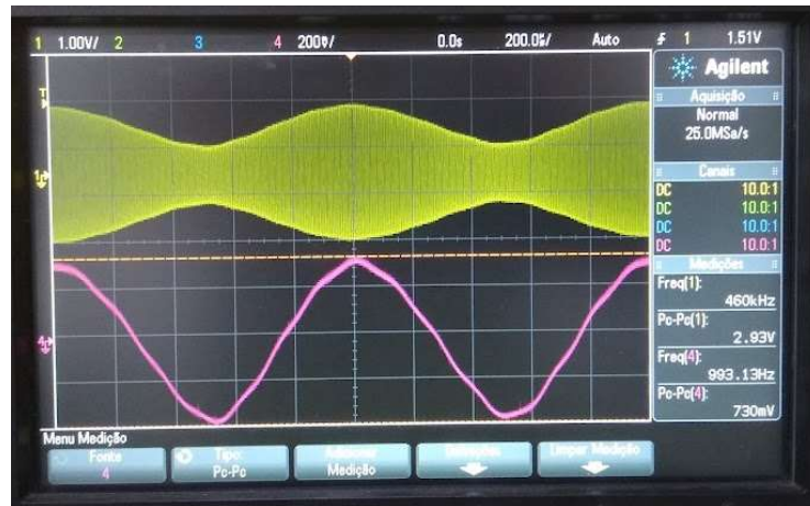
Figura 12- Receptor conectado via cabo: sinais AM (amarelo) e detectado (vermelho) medidos na entrada e saída do detector de envelope, respectivamente
