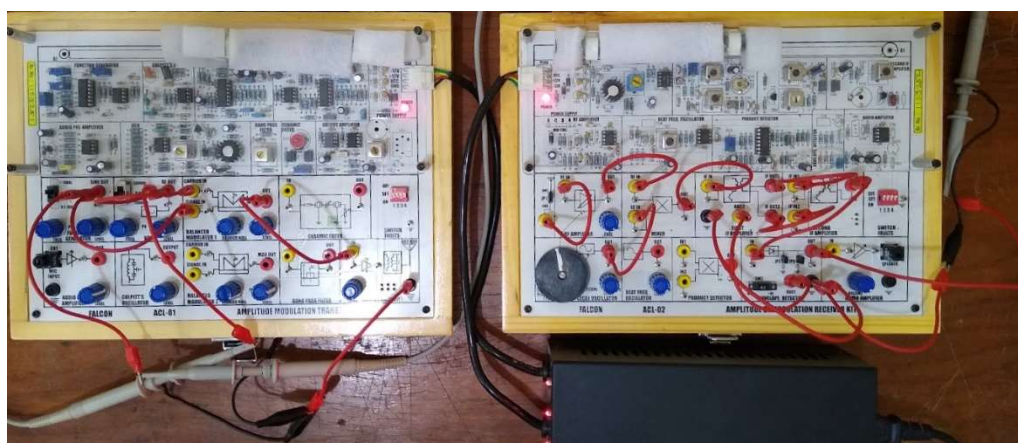
Figura 14- Montagem do receptor AM-DSB usando detector de envelope conectado via antena
