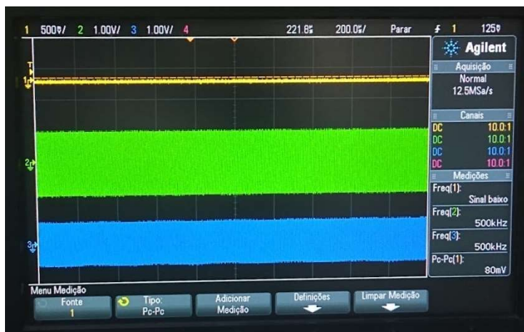
Figura 8- Saída do modulador AM-DSB (azul) aplicando na entrada do modulador um sinal modulante nulo (amarelo) e a onda portadora (verde)
