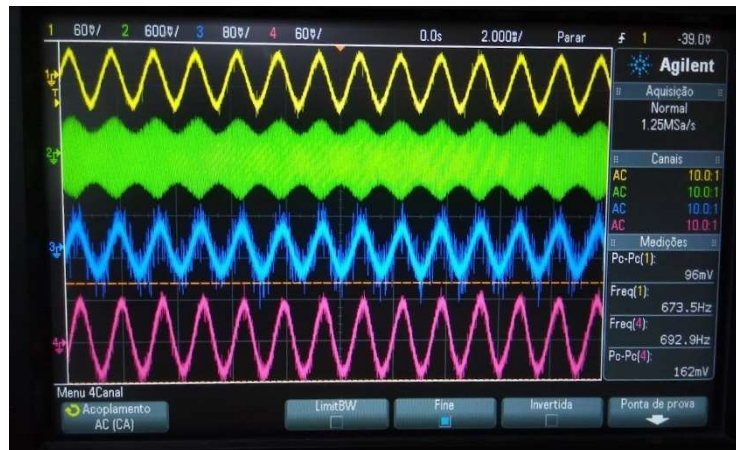
Figura 42- Montagem detector de quadratura: Sinal modulante (amarelo), sinal na saída do limitador (verde), sinal na saída do detector de quadratura (azul) e sinal recuperado na saída do filtro passa baixa (vermelho)
