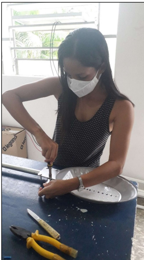
Figura 21: Montagem das luminárias de LED.
