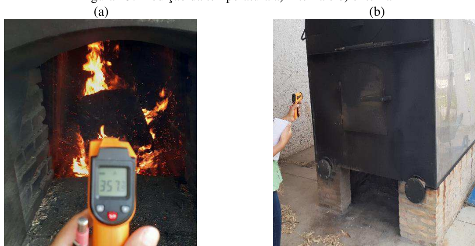
Figura 13: Medição da temperatura a) interna e b) externa
