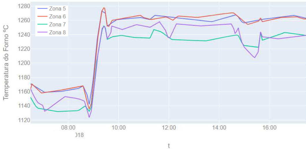
Figura 13 – Perfil de temperatura do forno para as 4 zonas finais
