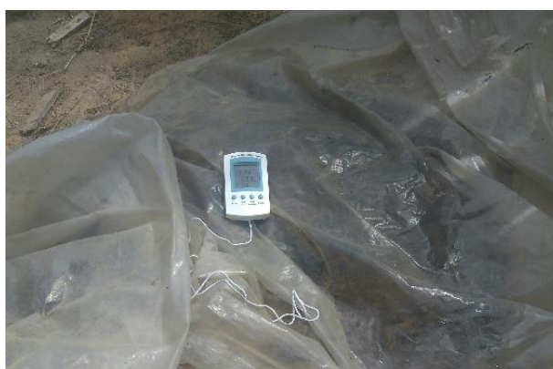
Figura 4. Monitoramento de temperatura da compostagem através do Termo higrômetro.
