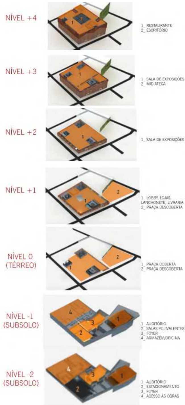
[FIGURA 40] ESQUEMA DE PROGRAMA DE NECESSIDADES POR PAVIMENTO DA EDIFICAÇÃO. FONTE: ADAPTADO DE < HTTPS://WWW.YOUTUBE.COM/WATCH?V=TARY48BEP-DI >
