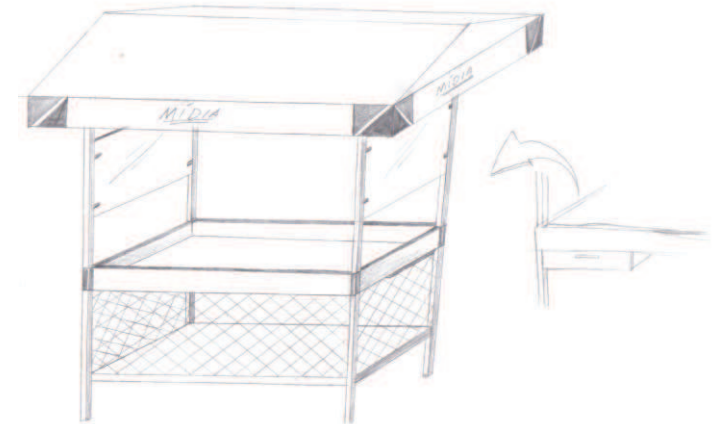
Fig. 54 Conceito 3. Totalmente quadrada. Toda em chapa 7/8, com exceção do espaço para identificação em PVC e do teto em lona Night- Day.
