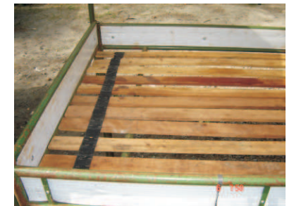
Fig. 11 Detalha do desgaste do revestimento de madeira, e do espaço entre um tábua e outra.
