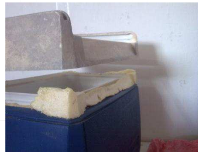
Isolante térmico da caixa térmica, poliuretano
