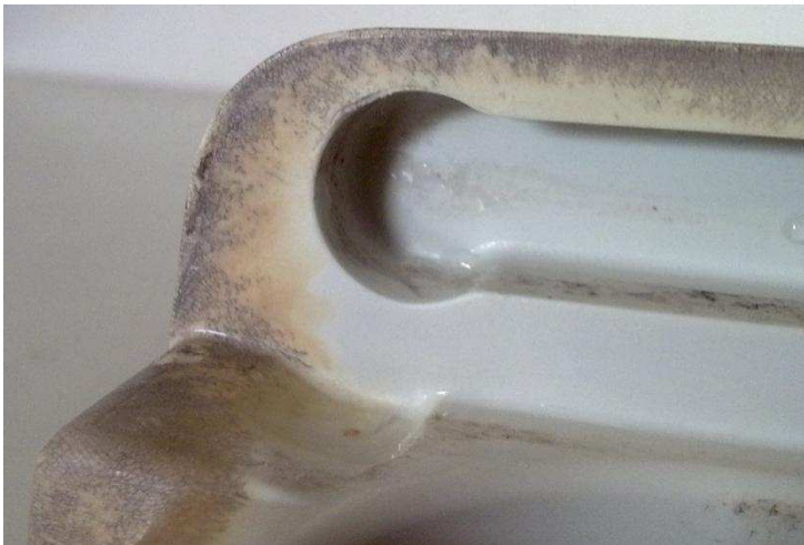
Figura 05: Detalhe do trilho que acomoda a tampa. Pode-se notar o desgaste sofrido pelo material pela exposição intensa a intempéries, enquanto nas áreas que não sofrem tanta exposição, continuam com estética satisfatória.
