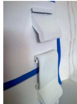
Figura 12 e 13: detalhe da aba de encaixe que atua como guia para a acomodação dos módulos extensores.
