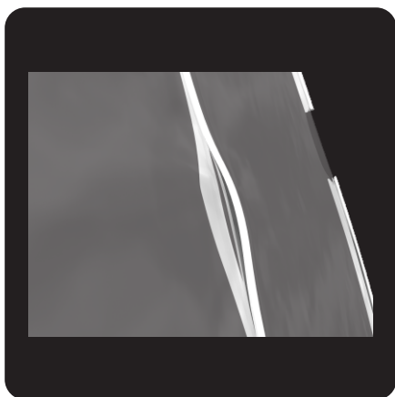
Passagem de líquido Duas entradas de comunicação entre as câmaras para distribuição simultânea do líquido na bolsa interior.
