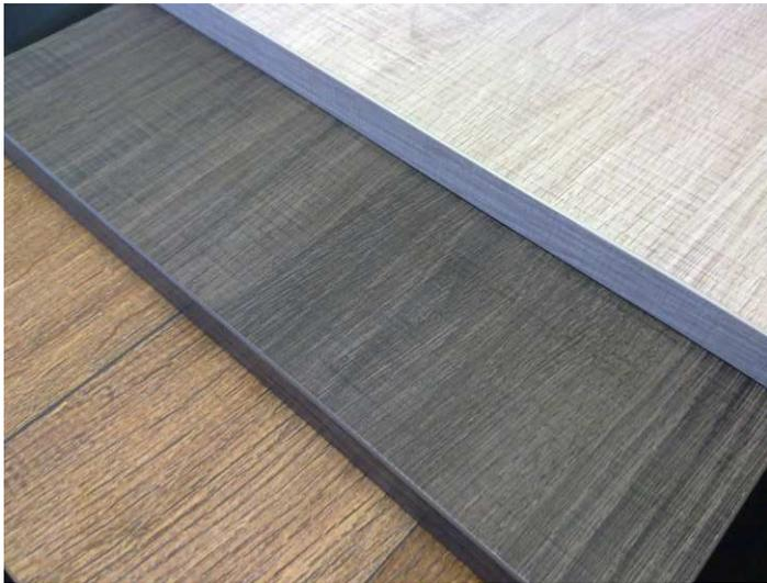
▼ Figura 13 -Placas de MDF com acabamento de pintura UV.
