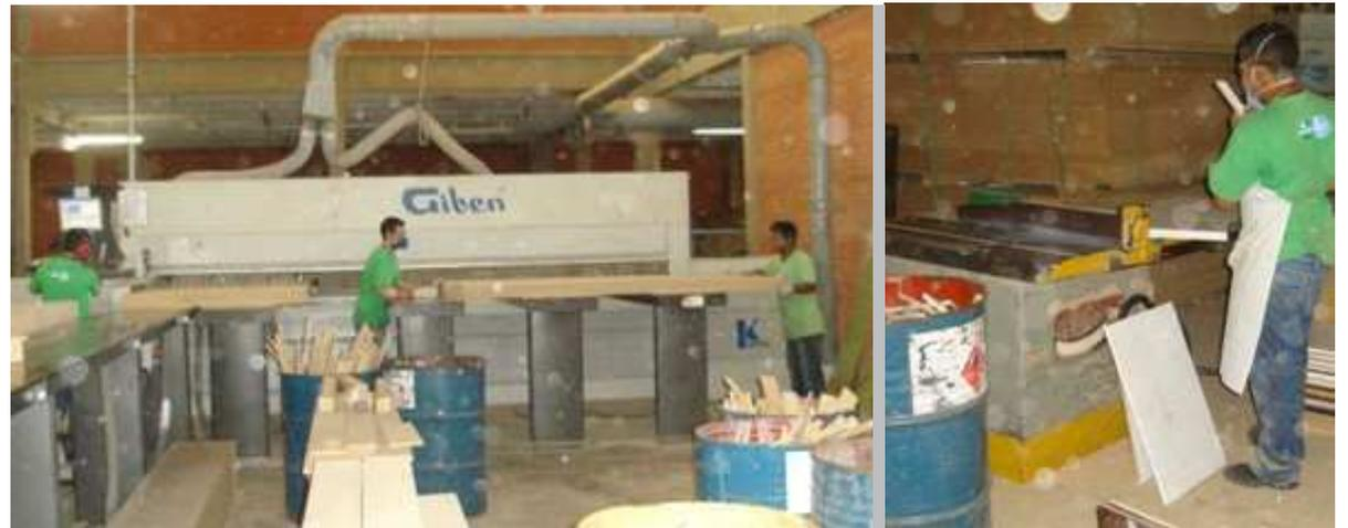
▲ Figura 14 - Máquina seccionadora e equipamento de corte manual respectivamente
