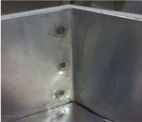
Figura 62 - Laterais fechadas através de rebites
