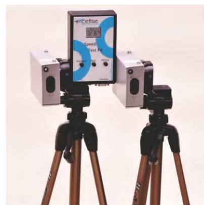
FIGURA 10: Fotocélulas - produto para medir frequência de tempos de maneira precisa.
