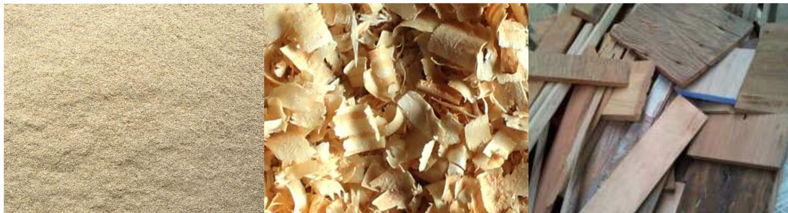
**Figura 13:** os três tipos de resíduos de madeira encontrados (da esquerda pra direita): pó de serra, cavacos ou maravalhas e recortes.
