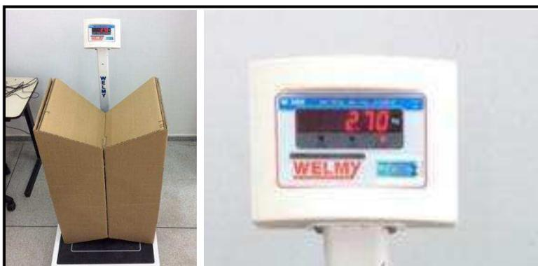
Figura 79: Peso de 1/4 da estrutura total (2,70kg).
