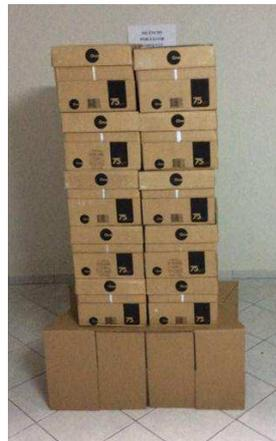
Figura 82: Teste de resistência (carga estática 240kg).
