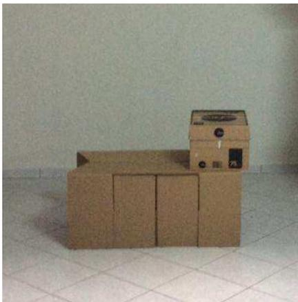
Figura 81: Teste de estabilidade (carga estática 24kg).
