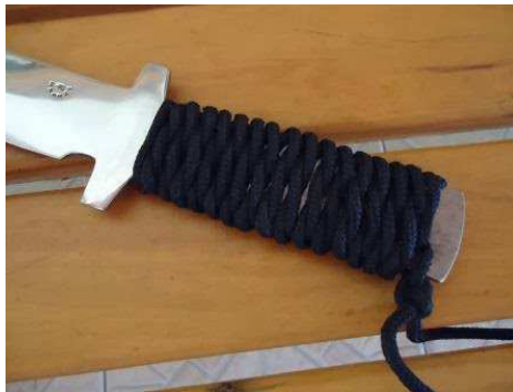
► Figura 09 - Cabo de faca feito com fio paracord
