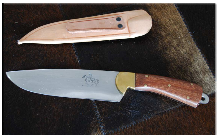
► Figura 10 - Exemplo de aplicação do latão na conexão entre a lâmina e o cabo, além da presença nos pinos de fixação. Acompanhado da baínha feita de couro.
