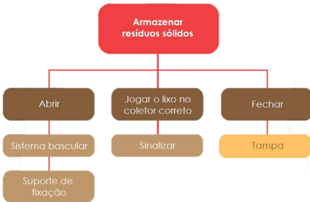
Figura 19 - Funções de um coletor de resíduos.
