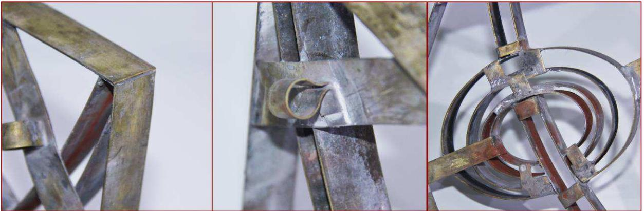
Figura 67: Fotografias dos detalhes de encaixe e soldagem do molde fabricado.
