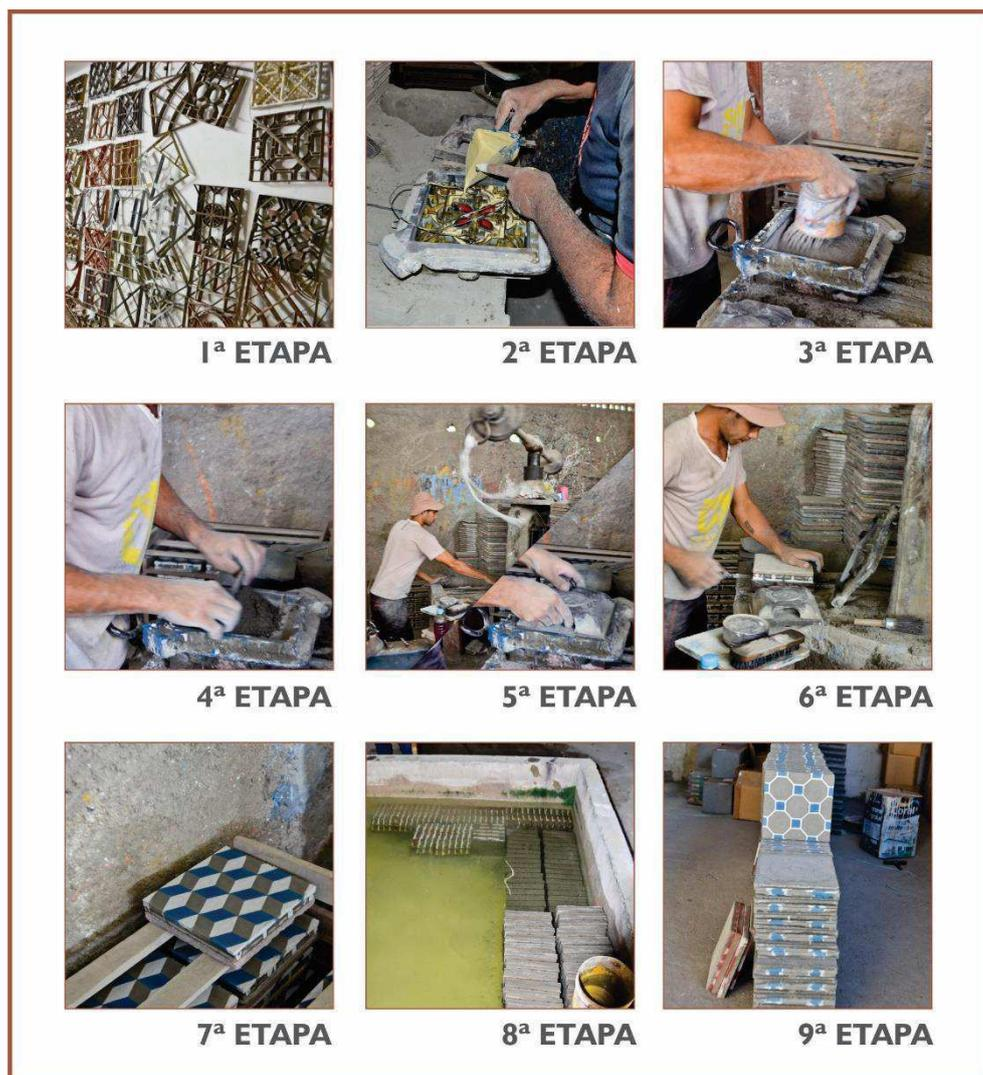
Figura 14: Etapas do processo de fabricação do ladrilho hidráulico.
