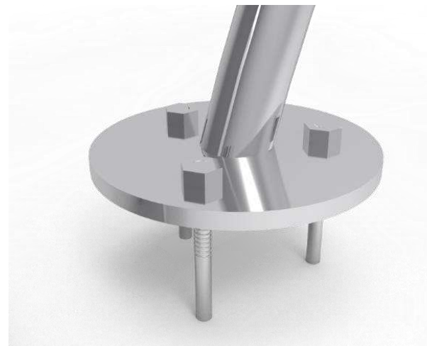
Figura 65: Detalhe do parafudo Bolt na base circular de aço.
