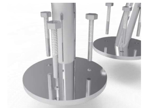
Figura 86: Parafusamento da base circular.
