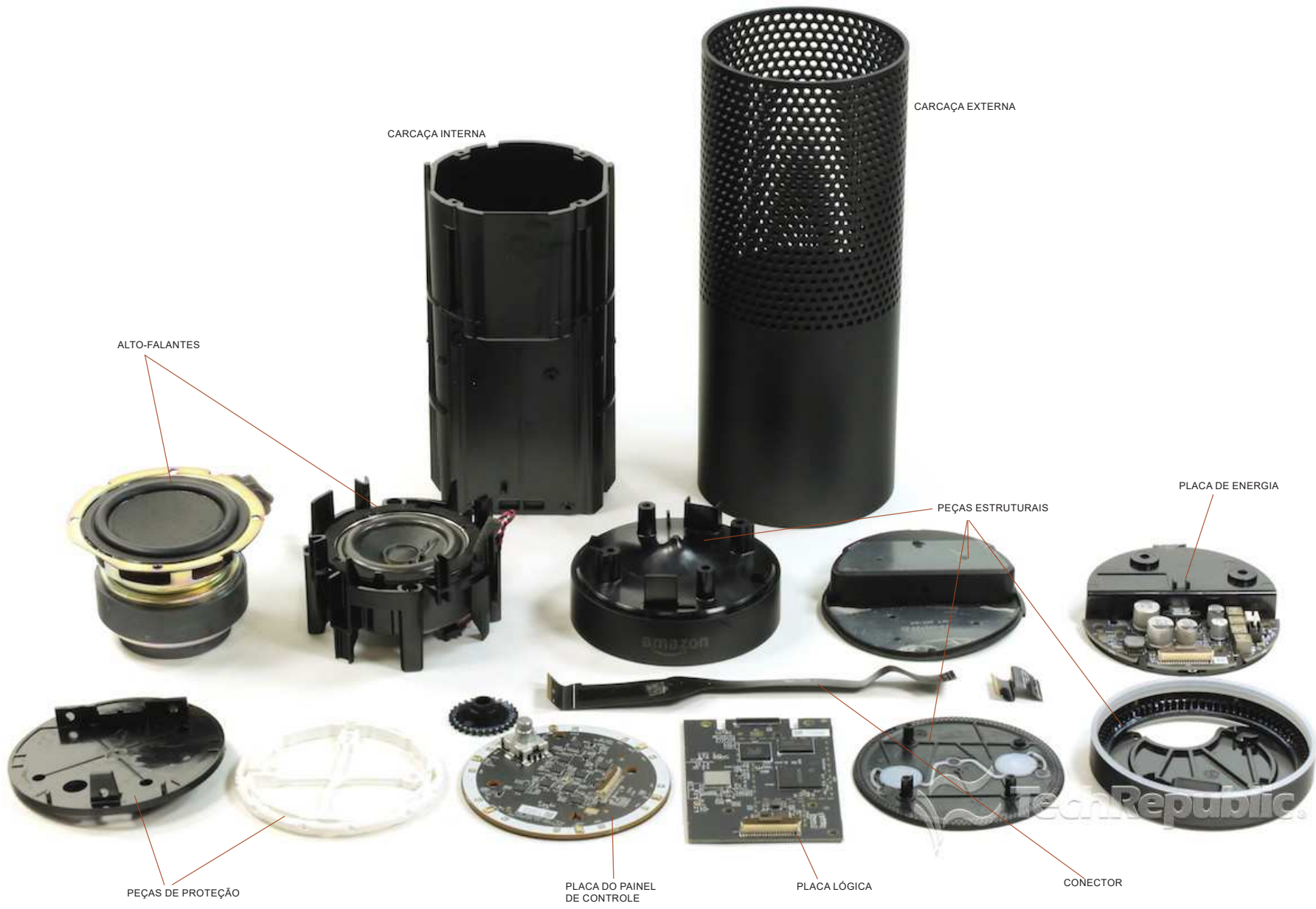
Figura 48 - Amazon Echo desmontado
