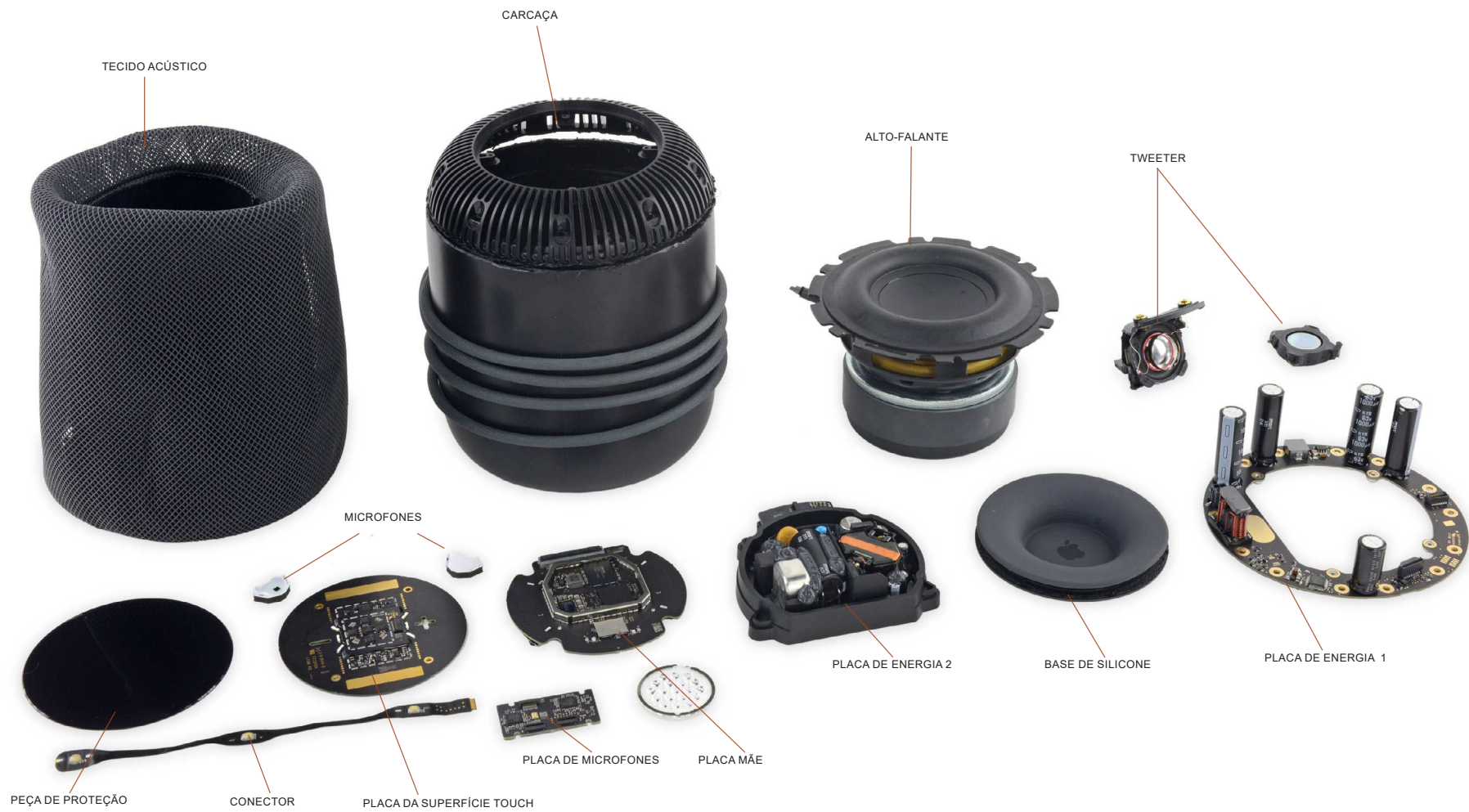
Figura 47 - Apple Homepod desmontado
