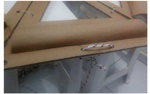
Figura 68: Corda amarrada na conexão externa do módulo.
