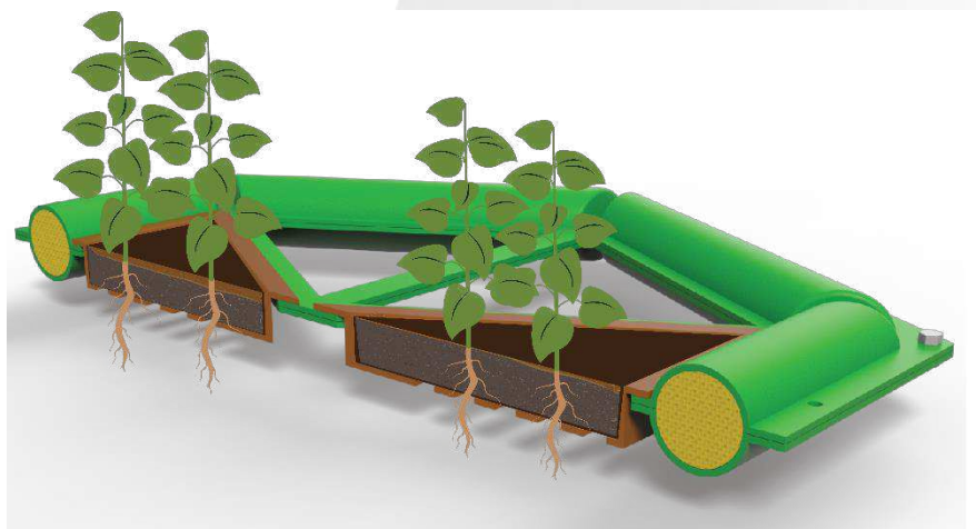
Figura 64: Corte do produto mostrando esquema de plantio.
