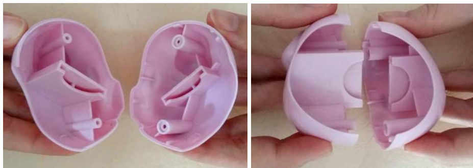
Figura 26. Exemplo de brinquedo que possui partes fabricadas por moldes macho-fêmea.
