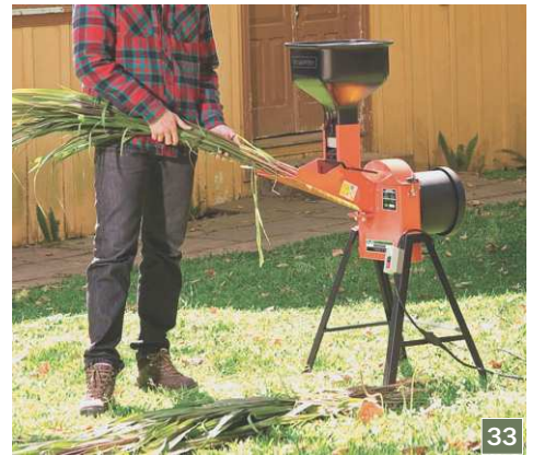
▲ Figura 33: Uso de uma máquina de trituração de resíduos orgânicos palhosos.
