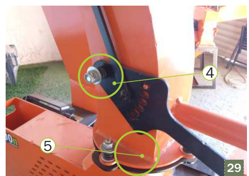
▲ Figura 29: Forma de fixação entre os elementos da pega e do defletor
