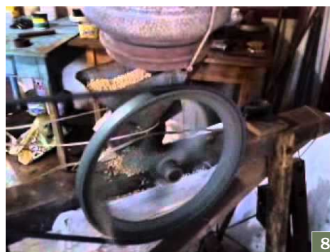
▲ Figura 08: Máquinas 'gambiarras' fora das normas de segurança
