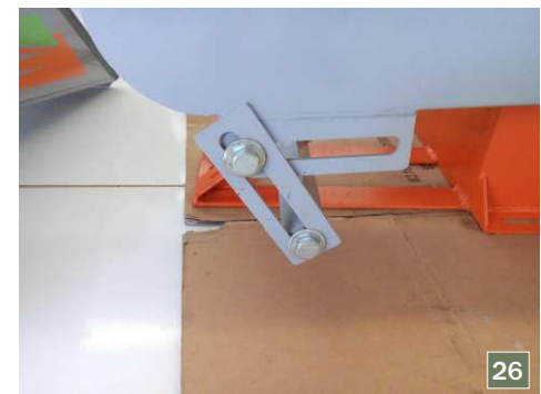
▲ Figura 25: Oblongos para ajuste entre as peças
